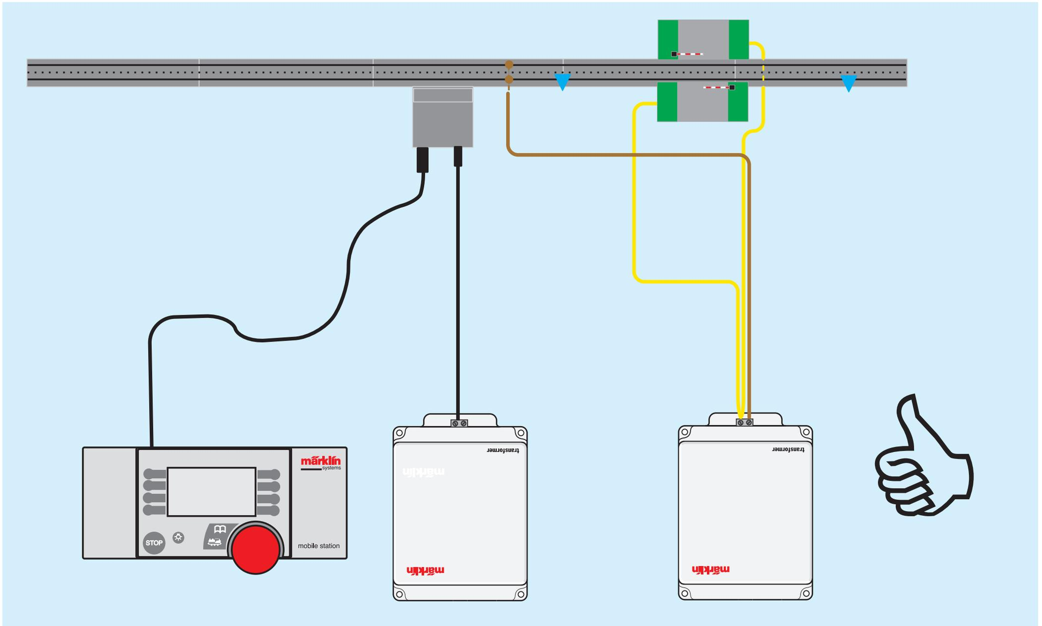
Die Leistungsversorgung der Schiebebühne erfolgt über einen eigenen Transformator. Die Fahrversorgung kann vom Gleis abgenommen werden. An den Versorgungstrafo der Schiebebühne können auch weitere Magnetartikel angeschlossen werden.
